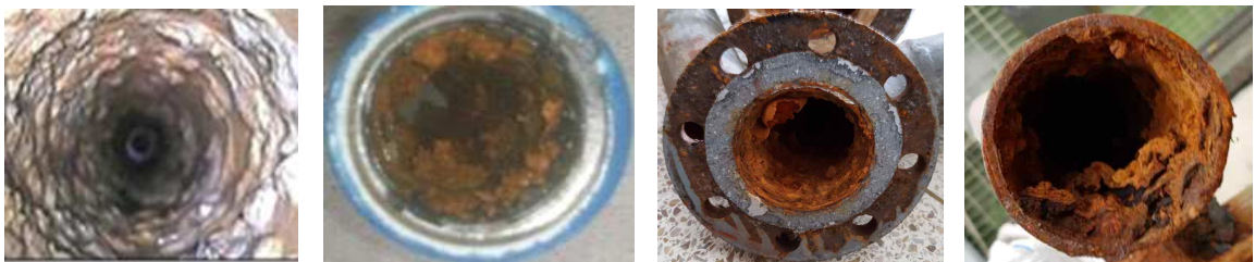
부식(Corrosion)의 종류 - 물 때 (Slim) 스케일 (Scale) 녹 (Rust)
